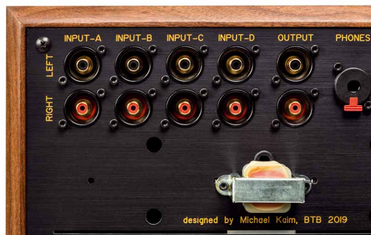
Die Anschlussbuchsen sind in die Deckelplatte eingelassen und sind so bequem von oben zu erreichen
