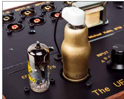
Zwei Pentoden besorgen die Verstärkung dieses Gerätes: links eine EF860, rechts die UF5
