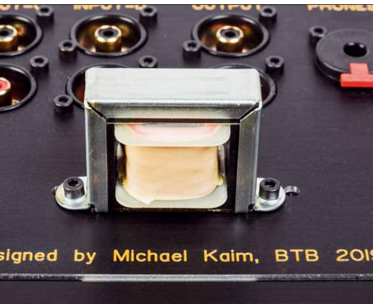
Auf Schaltnetzteil folgt Drossel: Die Anodenspannung wird gründlich gesiebt
