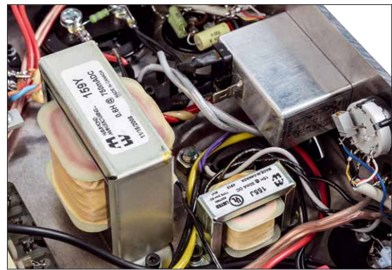
Die beiden Drosseln arbeiten in der Hochspannungs- und Gittervorspannungsversorgung. Das Netzfilter ganz rechts ist nicht unbedingt erforderlich
